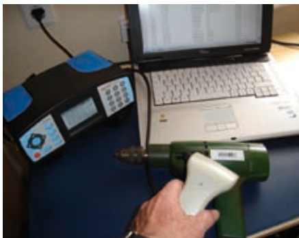
Bild 3: Rechnergestützter Prüfplatz mit Barcode-Scanner
