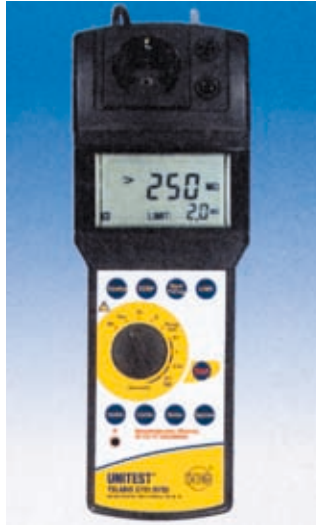
Bild 1: Prüfgerät mit Gut/Schlecht-Anzeige
